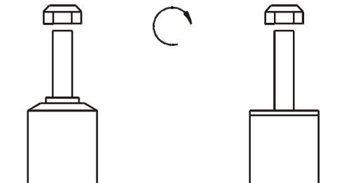
Um eine mögliche Zerstörung des Produktes zu vermeiden, darf zum Lösen und Anziehen der Muttern kein Schlag-schraubendreher verwendet werden. Selbstsichernde Muttern dürfen nur einmal verwendet werden!
