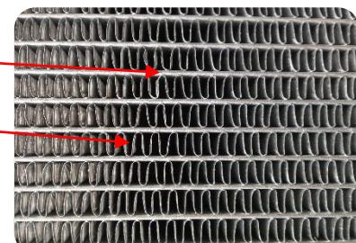
Vor ein paar Jahren sind Fahrzeughersteller dazu übergegangen das gelötete Alu / Kunststoff-Systemen (Kunststoffwasserkästen und Aluminiumkerne) auf ein Alu / Alu-System umzustellen. Hierdurch wird eine bessere Kühlung erzielt und Möglichkeit der Undichtigkeit auf ein absolutes Minimum reduziert.
