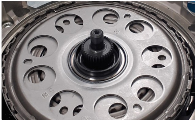
Bild 1: Mitnehmerscheibe mit kreisrunden Öffnungen
