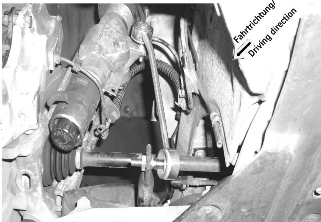
**Einbau Pendelstütze vorne rechts**
