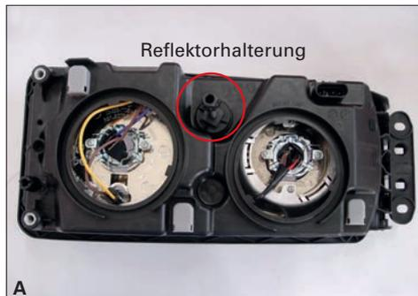
Den Reflektor mit einer Hand festhalten und mit der anderen die Reflektorhalterung herunterdrücken. Nach dem Lösen leicht schräg herausnehmen.
