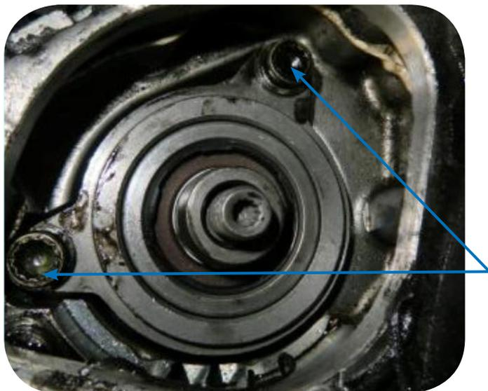
Sobald die Pumpe vollständig mit der Hand eingesetzt ist, ziehen Sie die Befestigungsschrauben abwechselnd jeweils um  $\frac{1}{4}$  Umdrehung an, bis die Pumpe vollständig anliegt.
