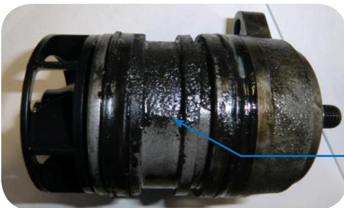
Beispiel einer alten Wasserpumpe, die Zeichen einer defekten Dichtung an der Ölseite aufweist.
