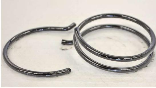
Bei der Untersuchung der Spannrolle wird häufig festgestellt, dass die Feder der Spannrolle gebrochen oder aus der Fixierung gesprungen ist.
