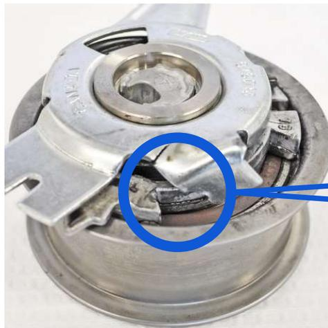
Die Rückenplatte ist stark verformt und gerissen.
