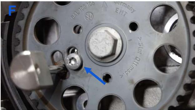
4. Lösen Sie die Mutter für den Spanner und entfernen Sie das Werkzeug T10265. Kontrollieren Sie nochmals den korrekten Sitz der Spannrolle (Bild C) und stellen Sie sicher, dass sich die Befestigungsschraube des Kurbelwellenrads im unteren Drittel des Schlitzes befindet.
