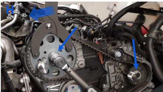
6. Setzen Sie den Nockenwellengegenhalter wie abgebildet auf das Nockenwellenrad. Drücken Sie den Gegenhalter gegen den Uhrzeigersinn und halten Sie ihn fest. Ziehen Sie nun die Befestigungsschraube des Nockenwellenrads und des Hochdruckpumpenrads mit 20 Nm an.
