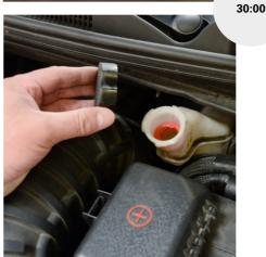
8. Bevor Sie als nächstes die Bremskolben mit einem passenden Rückstellwerkzeug zurücksetzen, sollten Sie vorher den Bremsflüssigkeitsstand überprüfen und gegebenenfalls etwas Bremsflüssigkeit absaugen. Beim Rückstellen der Kolben bitte unbedingt Herstellerhinweise beachten!
