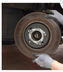
4. Entfernen Sie die Bremsscheibe und überprüfen Sie die Bremsenkomponenten auf Schäden und tauschen Sie diese gegebenenfalls aus.
