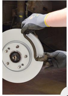
9. Tragen Sie auf die Anlage- und Führungsflächen der Bremssattelträger und der Bremsbeläge ein hochtemperaturfestes, metallfreies Dauerschmiermittel auf.
