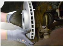
6. Montieren Sie nun die neue, passgenaue Herth+Buss Bremsscheibe auf der Radnabe. Die neue Bremsscheibe muss überall fettfrei sein, um später die Bremswirkung nicht zu beeinträchtigen. Hinweis: Eine Reinigung der Bremsscheibe oder Abtragung der Beschichtung vor dem Einbau ist nicht notwendig! Nach der Reparatur sollte das Fahrzeug während einer Probefahrt vier bis fünfmal aus etwa 50 - 60 km/h heruntergebremst werden, um die Beschichtung der Bremsscheiben zu entfernen.
