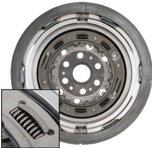
Version 1: Verspannring mit Federfensterflügel
