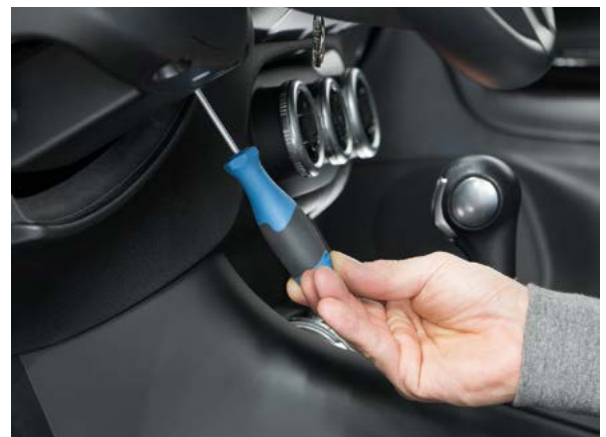
Die Zündschlüssel-Abzugssperre kann mit einem Schraubendreher außer Kraft gesetzt werden
