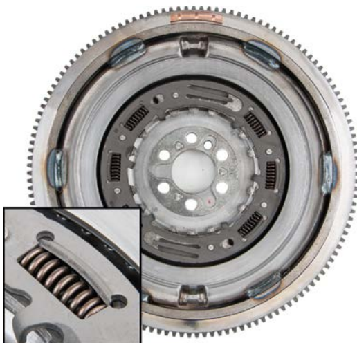
Version 2: Verspannring mit Federfensterflügel
