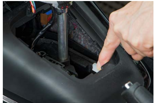
Über eine Drucktaste kann der Schalthebel entriegelt werden
