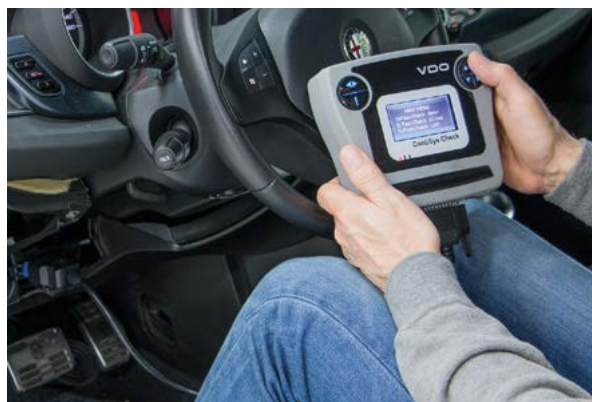
Grundeinstellung mit einem geeigneten Diagnosegerät
