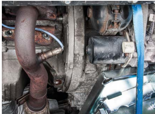
Getriebe so weit wie möglich an den Motor heranzuführen
