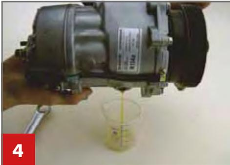
**4** Kompressor vollständig entleeren, Kupplung dazu drehen.
