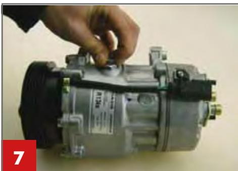
**7** Ablabsschraube mit Dichtung wieder einschrauben.
