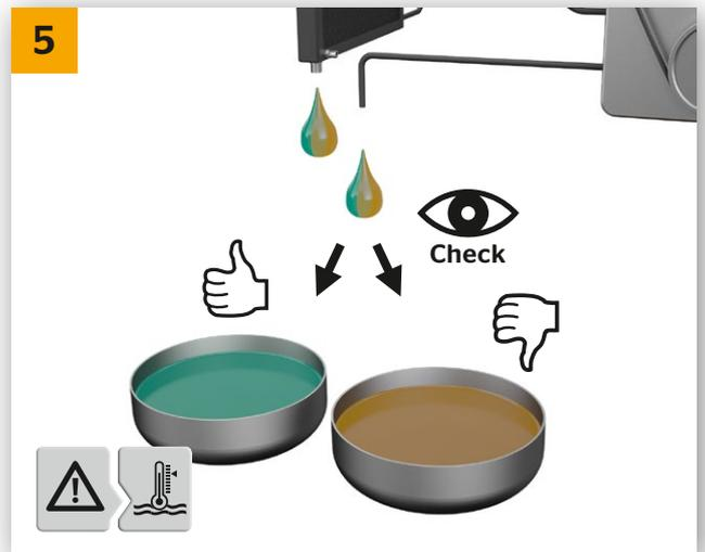
→ Reinigungsmischung erneut wie in Arbeitsschritt 1 ablassen (**Achtung Verbrühungsgefahr!**).
