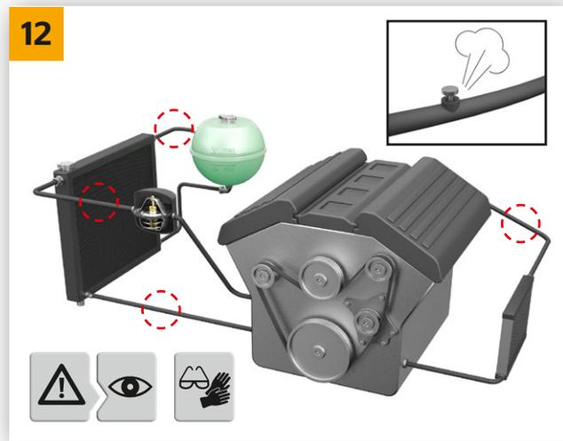
→ Nach Herstellervorgabe den Kühlkreislauf entlüften (ggf. Befüllgerät verwenden) und auf Dichtigkeit prüfen. Ein kurzzeitig auftretender, geringer Wasseraustritt an der Entwässerungsöffnung der Wasserpumpe ist möglich und hört nach kurzer Zeit auf.
