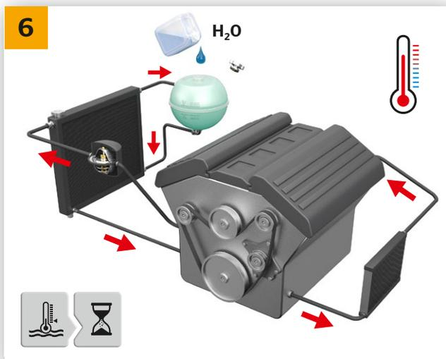
→ Den Kühlkreislauf mit klarem Wasser befüllen. Motor bei 2500 U/min auf Betriebstemperatur bringen und das Wasser erneut ablassen wie in Arbeitsschritt 1 und 5 beschrieben.
