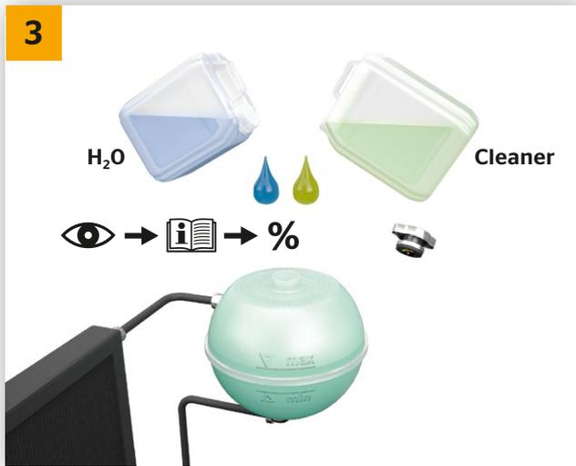
→ Klares Wasser mit Reinigungszusatz (z. B. MB A0009891025, Liqui Moly 3320, etc.) im richtigen Mischungsverhältnis mischen und in das Kühlsystem einfüllen.
