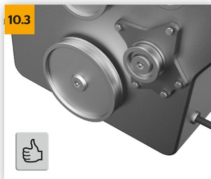
→ Liegt der Wasserpumpe eine Dichtung bei oder ist ein O-Ring vormontiert, darf keine Dichtungsmasse verwendet werden! Vormontierte O-Ringe vor der Montage mit Kühlmittel benetzen, kein Fett verwenden.
