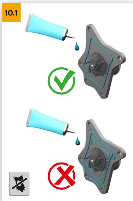
→ Die neue Wasserpumpe nach Herstellervorgabe einbauen. Dabei unbedingt die Anzugsdrehmomente und Hinweise zur Verwendung von Dichtungen / Dichtmitteln beachten.
