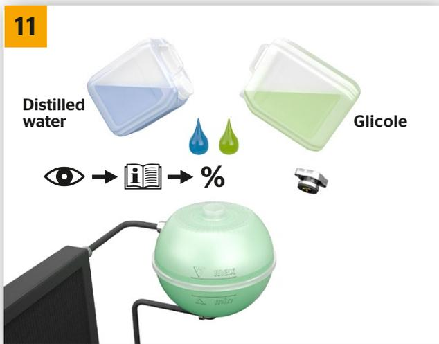
→ Neues Kühlmittel im richtigen Mischungsverhältnis aus Frostschutzmittel und Wasser auf das Kühlsystem auffüllen. Dazu nur die für das Fahrzeug freigegebenen Frostschutzkonzentrate verwenden. Je nach Fahrzeughersteller und Baujahr gelten unterschiedliche Grenzwerte für das verwendete Wasser (Härtegrad, pH-Wert usw.). Verwenden Sie im Zweifel destilliertes Wasser.
