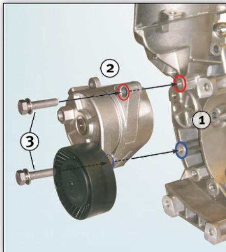
**Bild 4:** Einbausituation des mechanischen Spannarms
