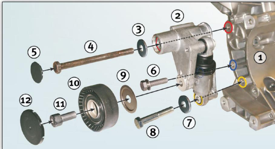
**Bild 5:** Einbausituation für den hydraulischen Umrüstsatz 533 0097 10 mit allen enthaltenen Komponenten
