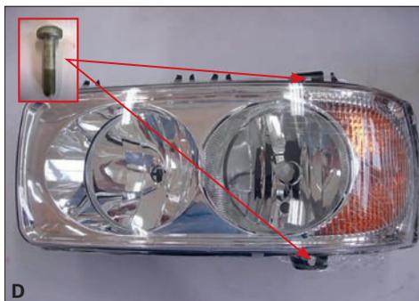
Nach Einbau der Lampe im Fahrzeug die Schraube festziehen (wie rechts dargestellt).
