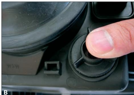
Reflektorhalterung herausnehmen: Mit der Hand auf die Reflektorhalterung drücken. Dann zum Lösen darauf drücken und schräg herausnehmen.
