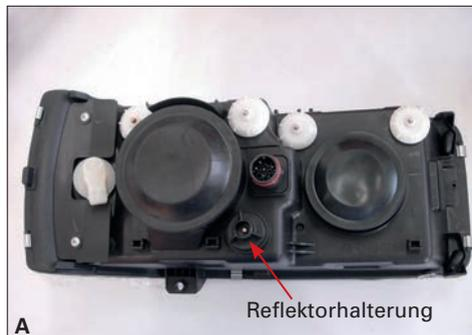
Die Reflektorhalterung durch Drehen lösen.
