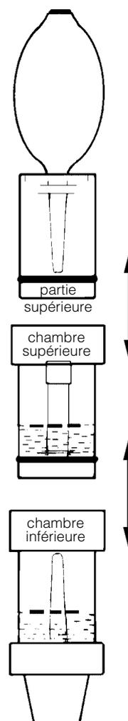
Séparer les deux chambres de la chambre supérieure en tournant et tirant doucement. Remplir premièrement la chambre inférieure du fluide de réaction bleu jusqu' au marquage (12 mm). Mettre ensuite la chambre supérieure et la remplir également du fluide de réaction bleu jusqu'au marquage. Mettre la partie supérieure avec la boule aspirante. L'appareil est prêt à l'emploi.
