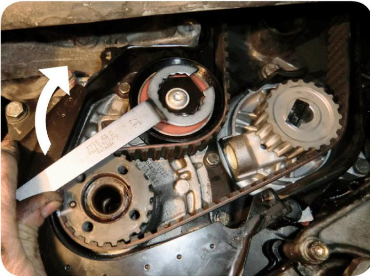
Verdrehen Sie mit dem vorgegebenen Werkzeug die Spannrolle im Uhrzeigersinn, bis der Zeiger der Spannrolle mittig auf der Einstell-Markierung der Grundplatte steht.
