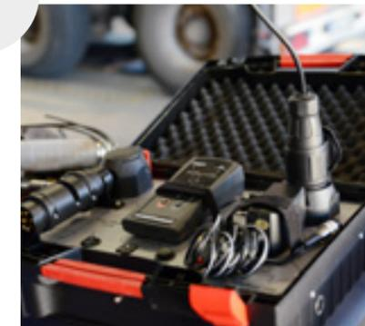
8. À l'aide du testeur pour prise de remorque (numéro d'article : 95980571), vous pouvez contrôler le fonctionnement des feux arrière une fois le montage complètement terminé. L'avantage : le testeur permet le contrôle, par une seule personne, de l'affectation de la prise de remorque ainsi que de l'éclairage de la remorque.
