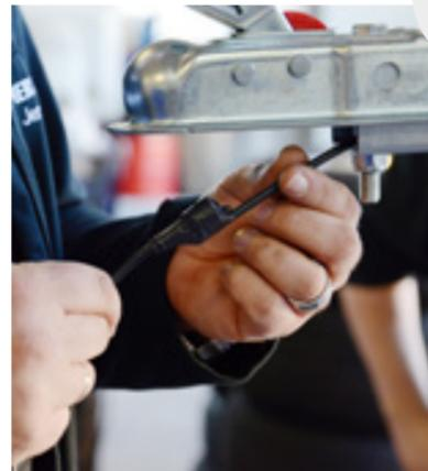
4. Introduisez maintenant le câble principal dans le logement de la remorque en utilisant un guide approprié.
