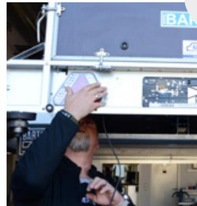
second feu arrière. Introduisez le câble raccordé dans le passage de la remorque et fixez le feu arrière au dos avec des écrous appropriés.
