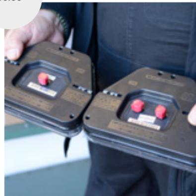
2. Le feu d'alimentation principale est doté de deux points de branchement à l'arrière. L'un est destiné à l'alimentation électrique, l'autre à l'alimentation du second feu.
