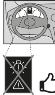
**In der Regel muss der LED CANbus an einem festen Fahrzeugteil, bevorzugt aus Metall, außerhalb des Scheinwerfers befestigt werden.**
