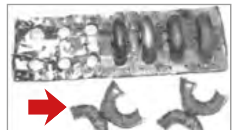
Abb. 3 zeigt wie Korrosion die Aluminiumröhchen im Kühlerblock auf eine typische Art angreift, wenn Kühlsysteme nicht gründlich gereinigt oder gespült worden sind, oder zu wenig / verkehrter Frostschutz verwendet wurde.
