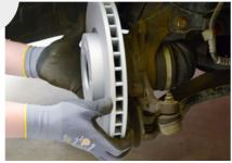
6. Montez ensuite le nouveau disque de frein sur mesure Herth+Buss sur le moyeu de roue. Le nouveau disque de frein doit être parfaitement exempt de graisse pour garantir un freinage efficace. Remarque : il n'est pas nécessaire de nettoyer les disques de frein ou de retirer le revêtement avant le montage ! Après la réparation, effectuer un parcours d'essai avec le véhicule et freiner quatre à cinq fois à 50 à 60 km/h pour retirer le revêtement des disques de frein.
