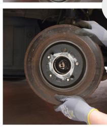
4. Retirez le disque de frein, effectuez un contrôle visuel des composants du frein, et remplacez-les le cas échéant.
