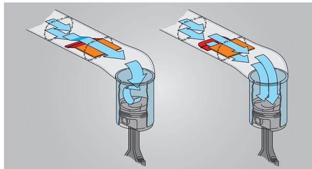
Tumbleklappe: Wirbel senkrecht zur Achsrichtung des Kolbens
