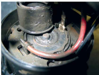
Aggressives Abgaskondensat im Antriebsmotor einer Sekundärluftpumpe
