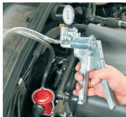
Prüfen eines Sekundärluftventils mit einer Unterdruckhandpumpe
