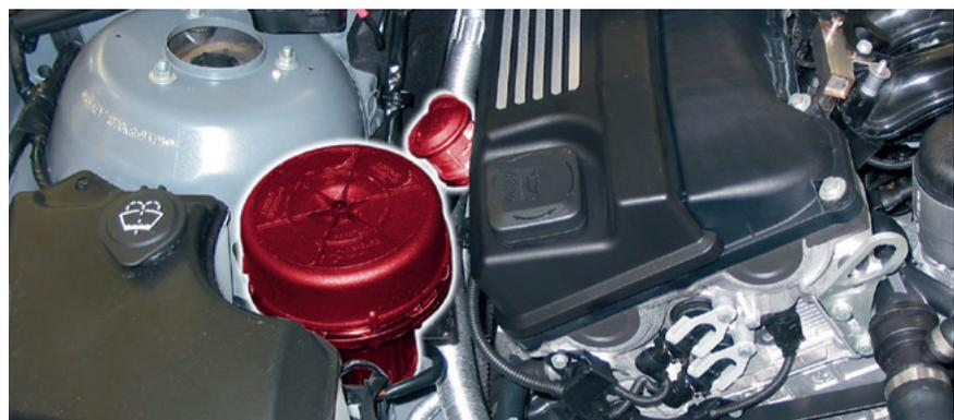
Sekundärluftventil und Sekundärluftpumpe im BMW E46 (hervorgehoben)
