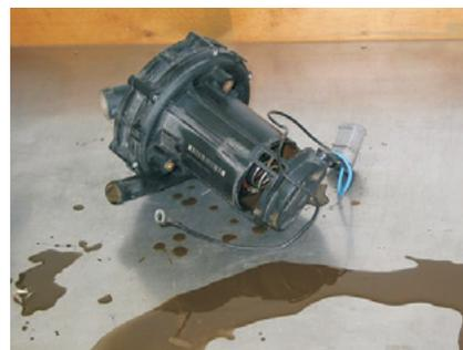
Flüssiges Abgaskondensat aus einer Sekundärluftpumpe
