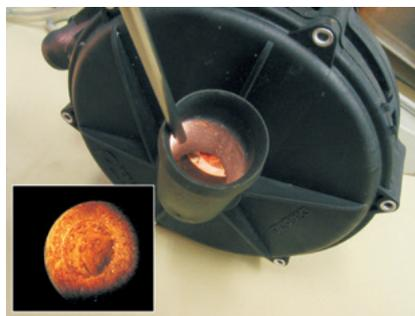
Blick in den korrodierten Einlauf einer Sekundärluftpumpe
