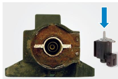
Korrodiertes Umschaltventil (geöffnet)
