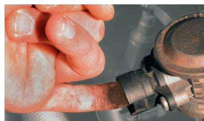
„Fingerprobe“ am Sekundärluftventil im BMW 520i (hervorgehoben)
