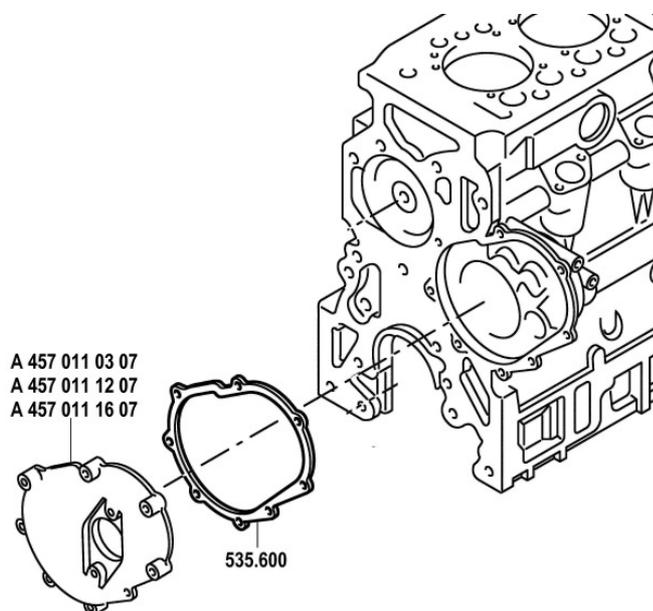
Zur besseren Abdichtung des Nockenwellenrad-Deckels am Zylinderkurbelgehäuse wurde eine neue Metaloseal®-Dichtung entwickelt. Diese löst die bisher eingesetzte Dichtmasse an dieser Dichtstelle ab.
