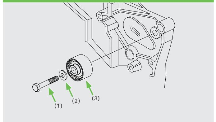
Die Umlenkrolle (3) mit der Unterlegscheibe (2) und Schraube (1) montieren.
