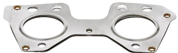
Zum einen ein drei lagiges Metallgichtsystem mit patentierter Halbsicke unter Verwendung von Metaloseal™ L der ElringKlinger als Ausgangsmaterial. Hinzu kommt auf der dem Auspuffkrümmer zu gewandten Seite ein Gleitlack auf Basis von Molybdän Disulfid / Graphit. Zusätzlich wird ein Bindemittel aus hochtemperaturbeständigem Harz hinzugefügt, welches vor allem der Reibverschleißreduzierung dient.
